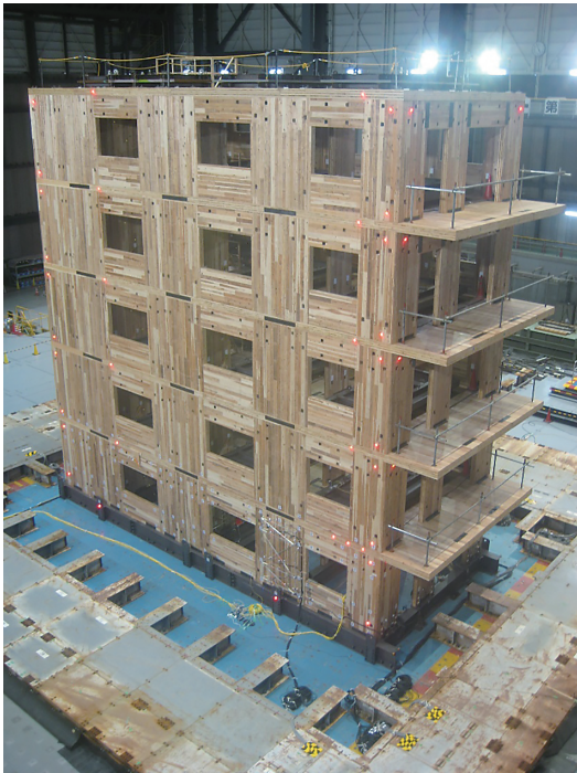
写真2 CLT建築物の振動台実験 中層建築物や多様な用途への展開に期待がある
