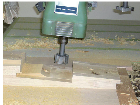
図6 木材加工におけるデジタル・ファブリケーションの例（コンピュータ制御の工作機で木材を加工）（木材会館/日建設計）
