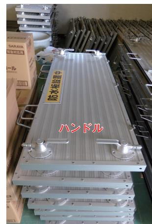
写真13 倉庫に保管されている止水板
