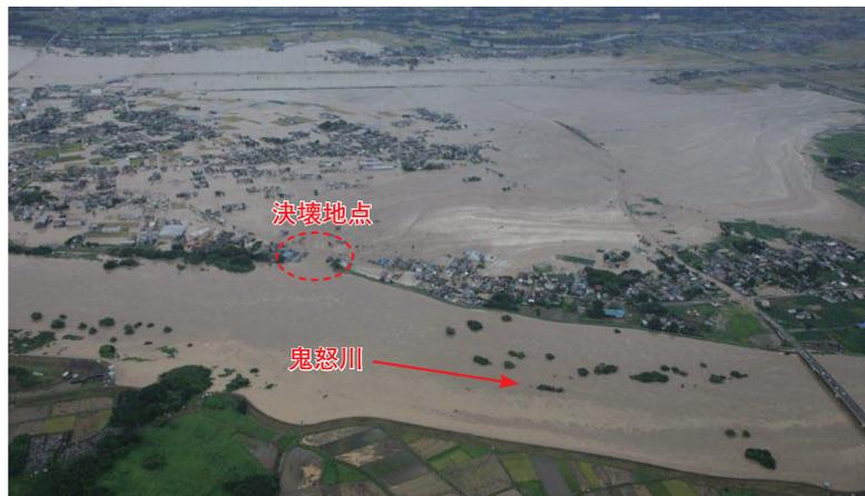
写真2 常総市三坂町の堤防決壊箇所(写真中央)(手前が鬼怒川で、流れは左から右へ)
