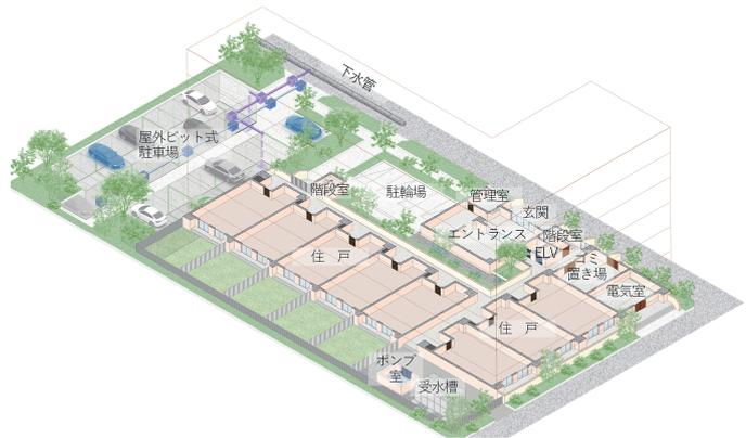
図5 郊外型モデルの外構及び1階部分
