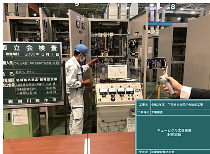
写真2 遠隔臨場の実施事例 受注者が監督職員へ状況を説明している様子
