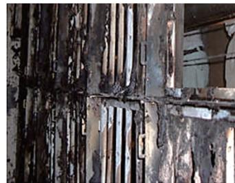
写真4 溶接火花により焼損した空調機フィルター
