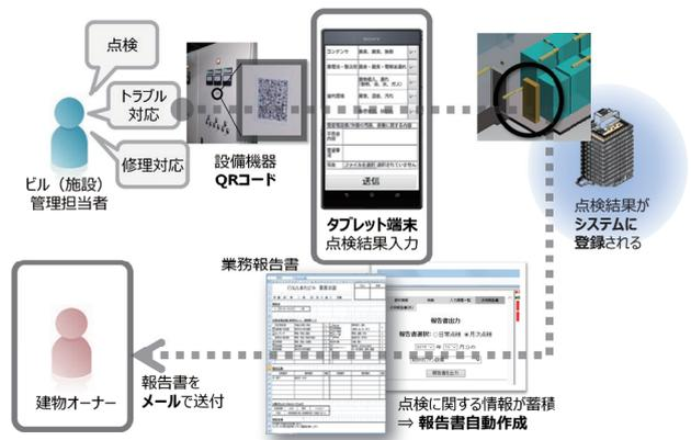
図10 「建築情報マネジメントシステム」日常点検業務の効率化のための管理手法
