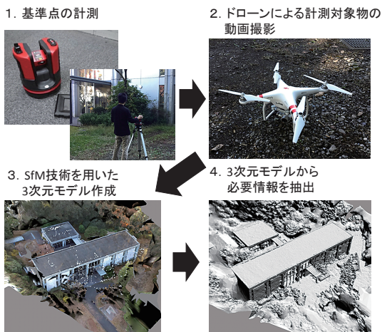
図4 ドローンを用いた建築物外形の記録手法
